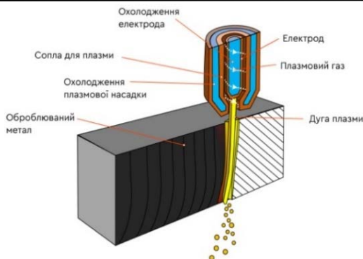
Рис. 1. Схематичне зображення процесу плазмової різки металу
